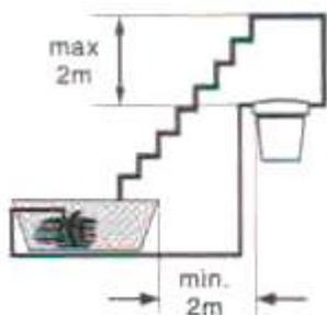
1.-Установить фильтр так, чтобы его невозможно было затопить водой. Закрепите фильтр так, чтобы он не упал в пруд. Его надо устанавливать не менее чем в 2 метрах от края пруда.
