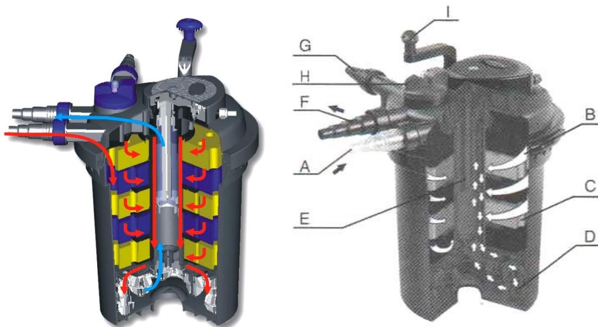
Данный напорный фильтр, оснащённый ультрафиолетовым излучением, представляет собой герметичную фильтровальную систему для биологической и механической очистки прудовой воды.
